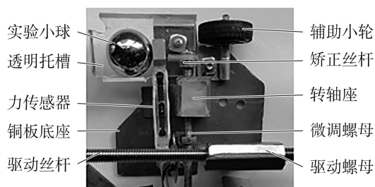
图 11 力传感器及矫正杠杆安装效果图
