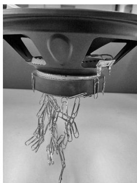
图 3 扬声器的吸铁性
