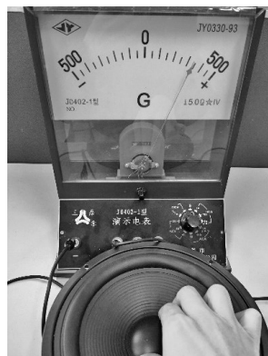
图 5 按压扬声器纸盆发电
