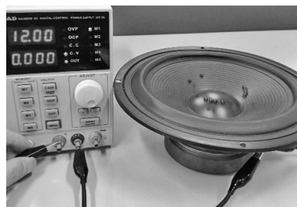
图 4 扬声器通电瞬间振动发声
