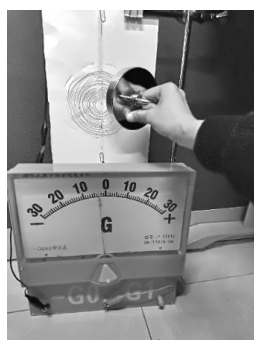
图 11 用螺旋式导线盘演示电磁感应现象
