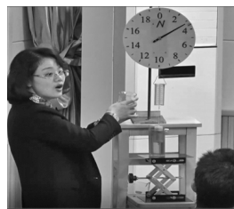
图5 介绍验证阿基米德原理的实验装置
