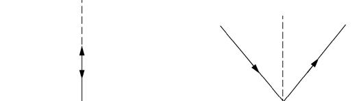
图1 光线垂直入射反射光路图
