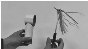
图 5 无叶风扇吹动验电羽
