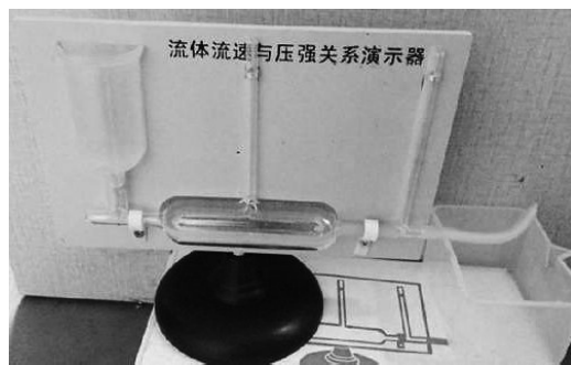
图 7 周边学校的流体压强与流速关系实验装置
