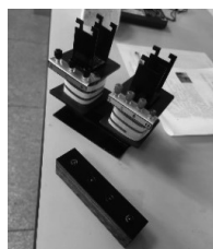
图 10 拆卸的“横梁”硅钢片 图 11 逐渐拉开变压器的“横梁”
