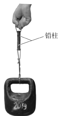
图 2 用铅柱吊起重物
